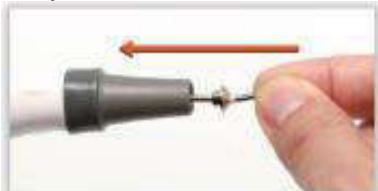
**⚠️** Насадку для конденсации необходимо заменять, пока модуль выключен. В противном случае это может вызвать ожоги.
