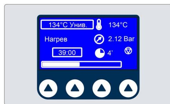
Если запрос PIN-кода установлен на конец цикла, при нажатии кнопки разблокировки дверки отобразится обзорная страница параметров цикла стерилизации.
