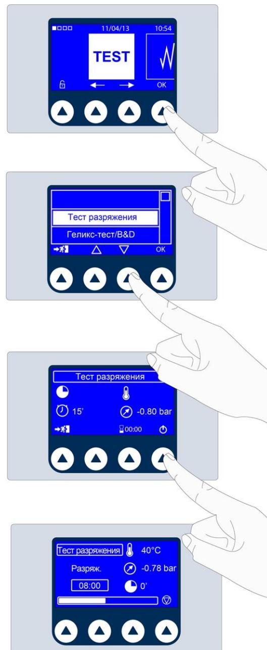
Этот цикл выполняется при пустой стерилизационной камере с установленными только держателем поддонов и поддонами.
