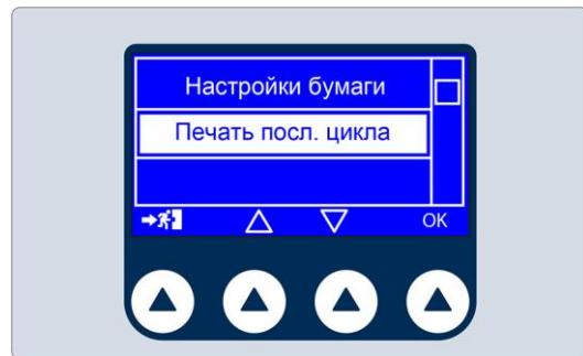
При выборе «Печать последнего цикла» с установленной опцией ОТЧЕТ распечатывается сводный отчет последнего цикла, в противном случае отображается страница НАСТРОЙКА ПАРАМЕТРОВ БУМАГИ.
