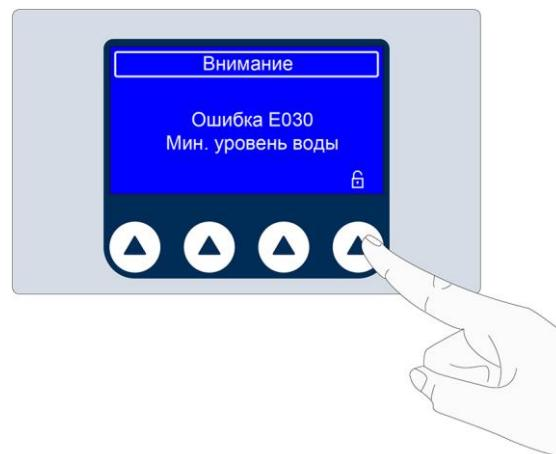
При удерживании кнопки блокировки («замок») в течение 3 секунд дверка стерилизатора открывается.
