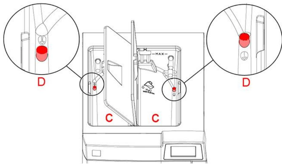
По завершении очистки установите фильтры (D) в баки (C).
