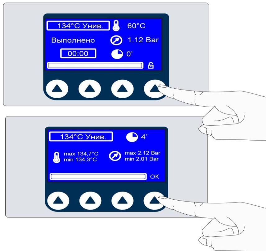
Нажатием кнопки OK пользователь подтверждает положительный исход цикла и разрешает выгрузку стерилизованного материала.
