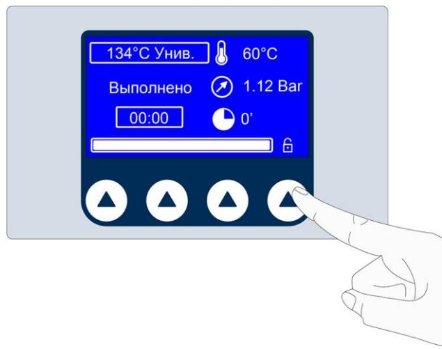
По завершении цикла при нажатии указанной кнопки представляется следующая страница, только если к стерилизатору подключен принтер с настройкой печати этикеток (задается в управлении печатью).
